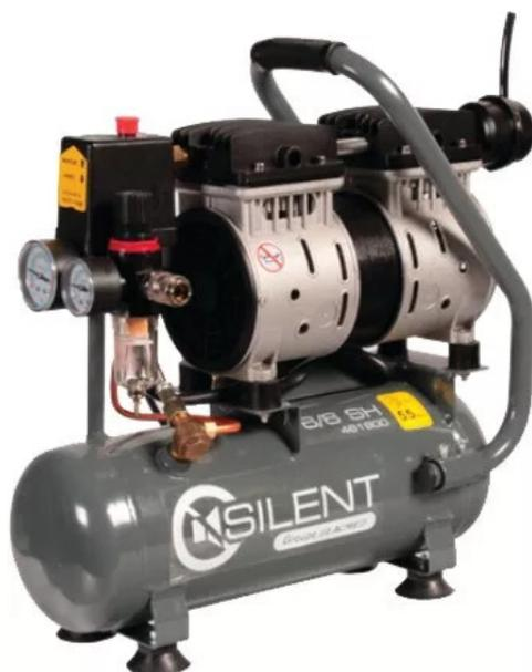
Groupe monobloc bicylindre à pistons oscillants, faible vitesse de rotation et patins amortisseurs. Double ventilation forcée. Manomètre de pression de cuve 0-12 bar, soupape de sécurité. Filtre régulateur avec 1 sortie raccord rapide. Robinet de purge 1/4 de tour pour purge périodique.
