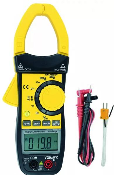
CAT III 600 V, CAT II 1000 V. Affichage LCD 4 chiffres rétro-éclairé.
