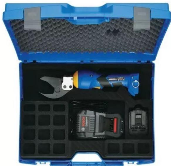
Pince coupante rechargeable à tête ouverte pivotante permettant de travailler sans fatigue grâce à sa prise en main ergonomique. Centre de gravité équilibré, éclairage LED de la surface de travail et bouton unique pour contrôler toutes les fonctions de l'outil. Arrêt retour manuel (MRS) , retour automatique à la fin du cycle de travail. Force de coupe 15 kN. Temps de coupe : 8 à 10 secondes. Livré en coffret avec chargeur et batterie Bosch 18 V. Poids : 2 kg.
