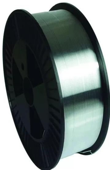
Fil plein pour le soudage MIG des alliages aluminium-magnésium de composition homogène à 5% de magnésium ou hétérogène. Utilisé en construction marine pour son excellente résistance à la corrosion d'eau de mer en milieux portuaire et ses très bonnes caractéristiques mécaniques mais aussi dans les domaines du ferroviaire pour le soudage de wagon de transport routier pour les bennes ou remorques de tracteur.
