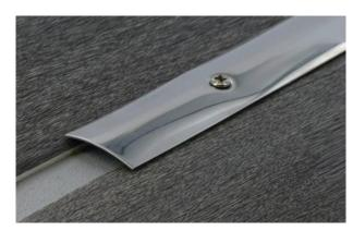
Seuil obtenu par profilage (à partir de matière en feuillard mise en forme à froid par des galets). L'anodisation apporte une couche dure à l'aluminium qui le protège contre l'abrasion et les rayures et permet de mettre en valeur l'esthétique du métal.
