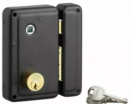
Coffre et gâche acier embouti époxy noir. Pêne 1/2 tour laiton. Double cylindre laiton, 5 goupilles,  $\varnothing$  25 mm, 3 clés.
