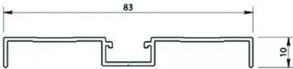
Permet de compenser l'épaisseur d'une plinthe sur toute la hauteur du mur.
