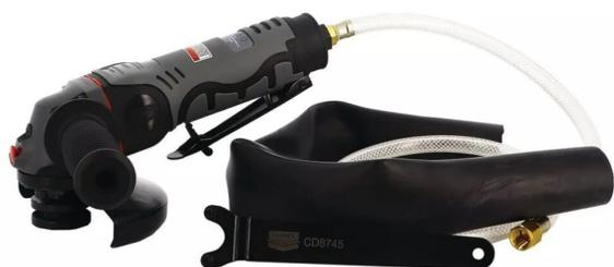
Machine confortable à utiliser grâce à son échappement canalisé (niveau sonore réduit) et à son faible niveau de vibration. Blocage d'écrou par vis pour une grande sécurité utilisateur.
