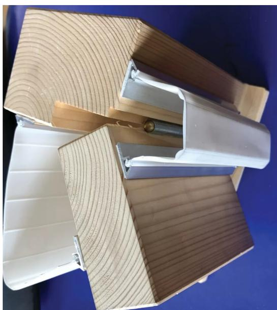
Profilé de protection en élastomère thermoplastique. Se pose côté charnières sur des portes intérieures de 40 mm d'épaisseur avec une ouverture maximale de 180° (écoles, station services, établissements médicaux...). Longueur 1850 mm. Largeur d'ouverture maximale avec les joints: 120°. Testé sur 50 000 cycles d'ouverture et de fermeture. Conforme à la norme NEN-EN 16654. Finition blanc 9010. Garantie 5 ans.
