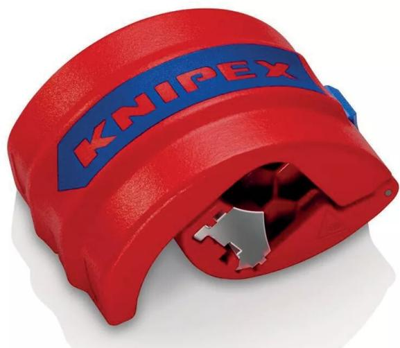
Peut couper les tuyaux d'écoulement en plastique à haute température et les conduits électriques en un rien de temps. Coupe les tubes en plastique non renforcé de  $\varnothing$  20 à 50 mm avec une épaisseur de paroi jusqu'à 2,4 mm. Avec mécanisme de verrouillage pour un transport sûr. Deux lames de rechange intégrées dans l'outil.
