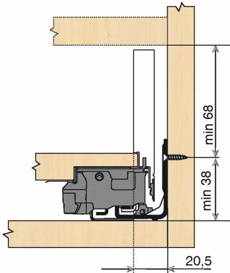
Tiroir à bords droits et fins épaisseur 12,8 mm montés sur coulisses invisibles extra-plates. Coulissement extra-léger. Amortissement BLUMOTION à la fermeture.
