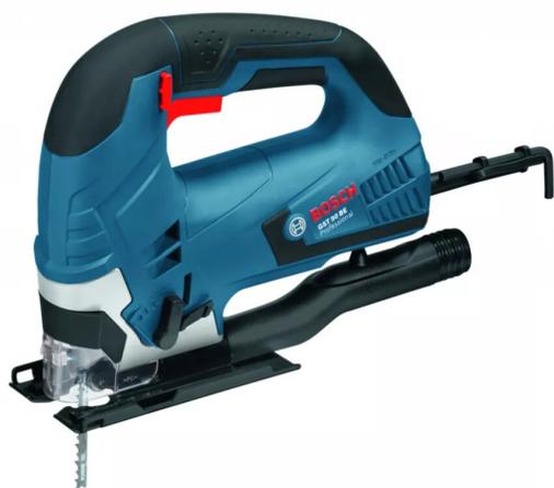
Grand confort grâce au système "SDS" Bosch, qui permet de changer de lame à la main, sans le moindre outil. Puissant moteur de 650 W pour une progression de travail ultra-rapide. Semelle en acier résistante à la déformation. Mouvement pendulaire à 4 positions pour des coupes rapides sans éclat. Régulation électronique pour une meilleure adaptation au matériau. Soufflerie de copeaux pour une vue dégagée, pouvant être désactivée pour une aspiration efficace des poussières.
