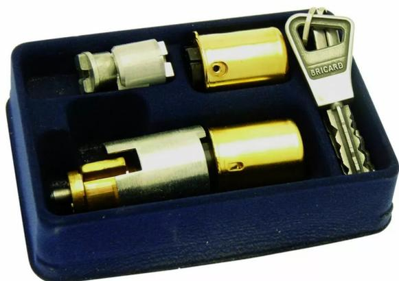
Protection contre la reproduction. Equipé de gorges à ancrage gênant l'ouverture par crochetage. Présence d'une pastille en acier carbonitruré en face avant. Gênant la progression du perçage. Rotor en polyacétal réduisant l'usure de l'ensemble. Livré avec carte personnelle et 3 clés.
