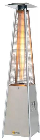
Fonctionne au propane (bouteille 13 kg non incluse). Montage facile en 30 minutes. Consommation 0,45 à 0,94 kg/h. Contrôle de flamme par thermocouple et sécurité anti-basculement. Puissance calorifique réglable de 5 à 13 kW. Brûleur équipé d'un allumeur électrique à pile. Livré avec tuyau d'alimentation gaz avec raccords et détendeur gaz propane.
