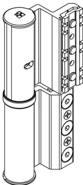
Paumelle à clamer Giesse pour profilé de porte à feuillure, réglable en trois directions et maintenant toujours les corps de la paumelle parfaitement alignés, quelle que soit la position de réglage latéral.
