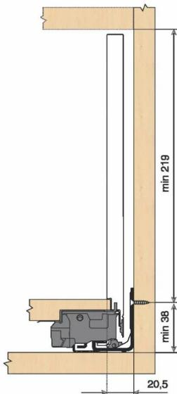
Tiroir à bords droits et fins épaisseur 12,8 mm montés sur coulisses invisibles extra-plates. Coulissement extra-léger. Amortissement BLUMOTION à la fermeture. Versions TIP-ON et TIP-ON BLUMOTION pour solutions sans poignées.
