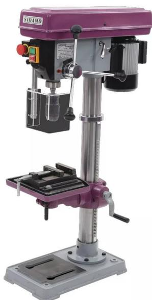
Colonne en fonte aciée. Transmission par courroies trapézoïdales.
