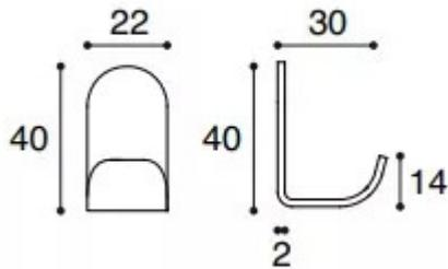
Un design innovant pour une nouvelle fonctionnalité : Les crochets sont fabriqués à partir de tôle d'acier et conçu pour une application sans vis et sans trous. Ils sont fournis avec un adhésif résistant (3M®) dans le kit de fixation.
