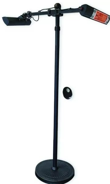
Appareil de chauffage par rayonnement. 2 lampes halogènes réglables indépendamment. 3 puissances de chauffe (max. 300 W). Alimentation 220-240 V. Livré avec 1 télécommande. Câble longueur 1,80 m. Domaines d'application : chauffage d'appoint, protection antigel (stockage, canalisations, machines), préchauffage/séchage (peinture, plâtre, carrosserie). Dimensions : L 1225 x l 500 x H 2180 mm. Poids 21 kg.
