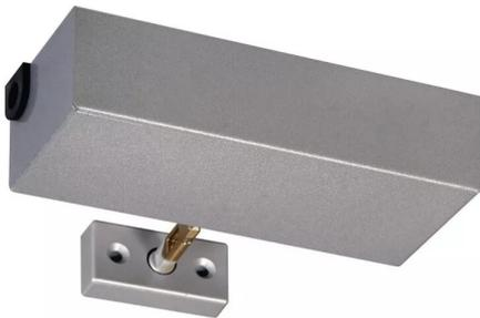
Pour porte 1 ou 2 vantaux en bois, acier, PVC ou aluminium. Raccordement à un CMSI possible en 24 Vcc ou en 48 Vcc avec une sélection automatique de la tension. Résistance à l'effraction de 600 kg en applique, grâce à ses accessoires et capots en acier laqué. Pose côté paumelles et opposé aux paumelles. Réversible droite/gauche. Consommation : 7,2 W. Déverrouillage automatique par manque de tension. Conforme à la norme DAS NFS 61-937.
