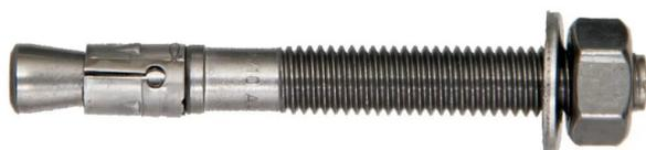
Applications : goujon universel à simple profondeur d'ancrage adapté aux usages courants de fixations lourdes sur béton non fissuré. L'épaulement sur tête permet d'éviter l'endommagement du filet lors de la mise en œuvre et le filetage long permet les fixations déportées.
