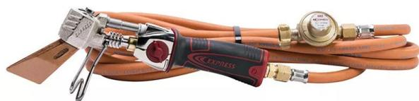
Equipement complet à allumage Piezo et volant de réglage affleurant et auto-freiné qui limite les risques de dérèglements. Doté d'un indicateur de réglage précis et d'un raccord tournant droit 3/8" gauche intégré à sa poignée, pas d'enroulement du tuyau. Brûleur caréné avec aspiration par l'arrière, l'injecteur est protégé contre les vapeurs de flux lors de la soudure. La clé BTR permet de remplacer l'injecteur ou de démonter le brûleur ou le carter soi-même.
