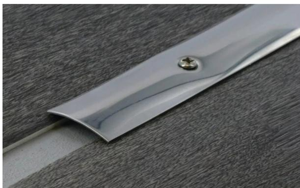
Seuil obtenu par profilage (à partir de matière en feuillard mise en forme à froid par des galets). L'anodisation apporte une couche dure à l'aluminium qui le protège contre l'abrasion et les rayures et permet de mettre en valeur l'esthétique du métal.
