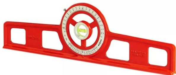
Appareil étudié pour établir et contrôler les inclinaisons. Lecture des inclinaisons par alidade graduée en degrés, en pourcentage et en rapports simples. Corps massif en alliage léger. Fiole antichoc usinée dans la masse, pratiquement incassable, garantie totale. Revêtement épais par poudrage électrostatique. Livré en coffret bois.
