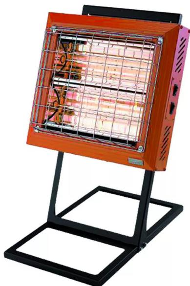
Appareil léger et peu encombrant sur socle équipé de 2 lampes halogènes haute performance. Réflecteur parabolique en aluminium. 2 allures de chauffe 1500 / 3000 W, grille de protection et poignée de transport. Mono 230 V. Domaines d'application : chauffage d'appoint localisé, préchauffage/séchage de peinture, plâtre, carrosserie, protection antigel (stockage, canalisations..). Dimensions : L 665 x l 430 x H 505 mm. Poids 8 kg.
