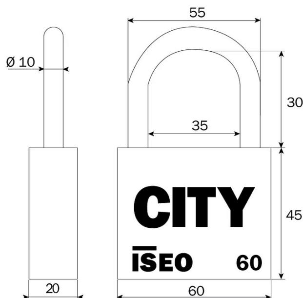
**Mécanisme de sûreté à goupilles anti-crochetage profil 5 goupilles. Ressort de verrouillage en bronze. Pastille de sécurité du verrouillage.**
