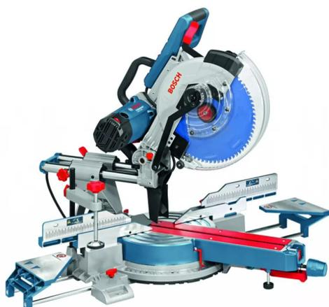
Capacité de coupe verticale de 120 mm. Régime variable capable d'adapter la vitesse de coupe au type de matériau. Inclinaison des deux côtés jusqu'à 47°. Verrouillage intuitif de l'angle d'inclinaison. Rallonges de table intégrées pour le soutien du matériau. Simplicité de remplacement de la lame. Présélection du régime entre 3100 et 4000 trs/min.
