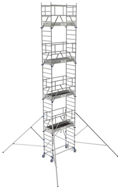
Le Totem 2 box 180 est un échafaudage roulant en aluminium certifié NF. Son système de liaison breveté Ergoblock, permet un blocage fiable en un seul geste. Ses plinthes anti-chûte d'outils de 150 mm en aluminium amovibles sont rapides à mettre en place, sans vis ni outils. 4 planchers. Roues  $\varnothing$  200 mm réglables sur 175 mm par palier de 12,5 mm.
