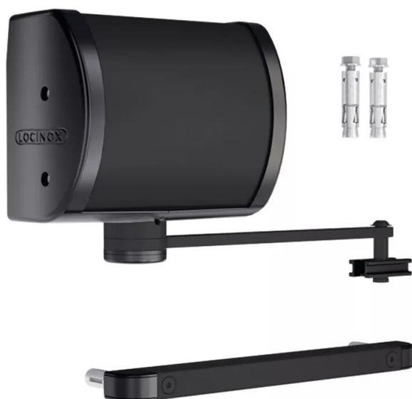
A fermeture automatique avec vitesse et à-coup final réglables. Force de fermeture sur l'angle d'ouverture complète 120°. En aluminium anodisé résistant aux rayures, à la corrosion et aux variations de température. Souplesse d'ouverture 19 Nm maxi. Fourni avec fixations Quick-Fix pour métal, goujon d'ancrage pour béton.
