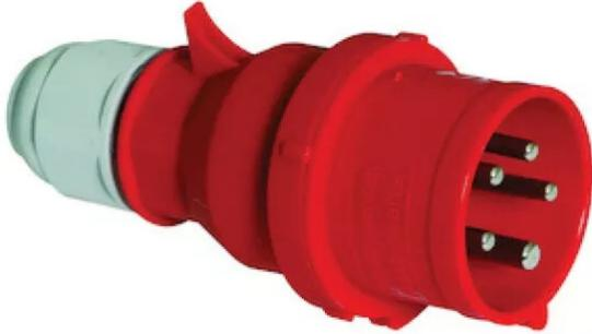
Fiche inverseur de phase Quick-Connect avec presse-étoupe Multi-grip et décharge de traction intégrée. Boitier polyamide, contacts en laiton nickelé. Connectique à ressort sans vis avec bornes à ressort femelle. Pour câbles  $\varnothing$  11-23 mm. Entrée de câble raccord à écrou. Tension 200/346 à 240/415 V. IP44.
