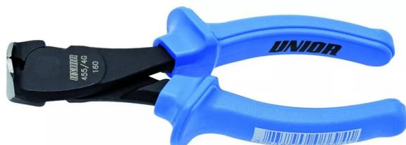
Présentation : acier à outils spécial. Entièrement forgée et trempée. Mâchoires traitées par induction pour plus de dureté. Tête surfacée et finition phosphatée suivant norme DIN 12476.
