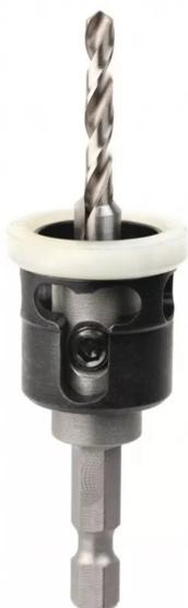
Spécialement adapté pour la pose de vis à tête cylindrique. Permet de réaliser en une seule opération un avant trou et le fraisage pour loger la tête de vis. Butée de profondeur réglable avec bague plastique pour protéger les lames lors du vissage.
