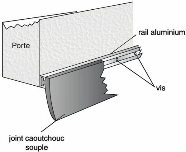
La forme et la souplesse du joint garantissent l'étanchéité des bas de porte de garage quelque soit la forme de l'interstice laissé entre la porte et le sol. Le montage du joint caoutchouc se fait par l'intermédiaire d'un rail en aluminium fixé sur la porte à l'aide de vis.
