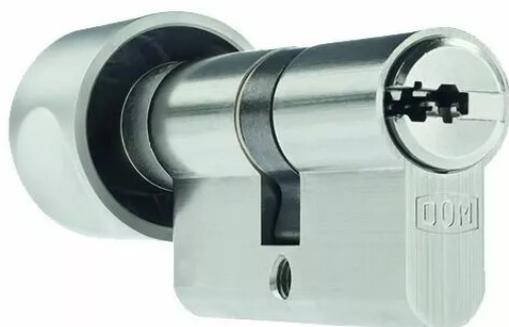
Cylindre à profil européen en laiton nickelé composé de vingt et un points de contrôle pour l'ouverture du cylindre et de cinq goupilles actives sur ressort bronze.
