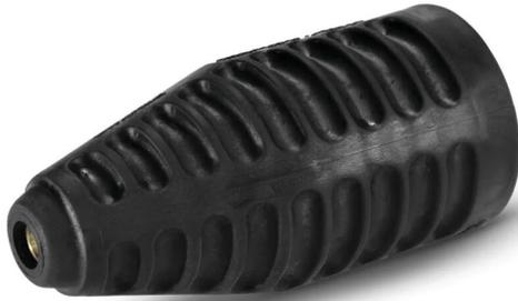
Buse et bague de roulement en céramique, longue durée de vie. Max. 300 bar/30 MPa, 85°C. Filetage des raccords M18. ø 50.
