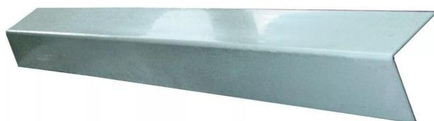
Répartit la pression des sangles sur les charges. Protège les arêtes des charges arrimées et les sangles des arêtes vives ou abrasives. Solidarise les charges modulaires. Le modèle blanc est en PVC. Le modèle noir est en polyéthylène. Chaque cornière a une épaisseur de 5 mm.
