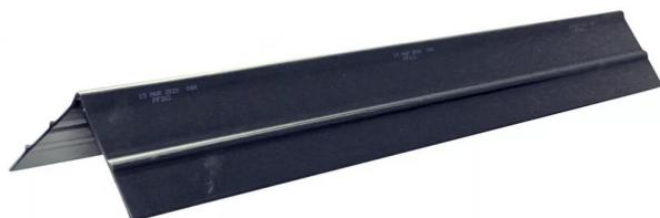
Répartit la pression des sangles sur les charges. Protège les arêtes des charges arrimées et les sangles des arêtes vives ou abrasives. Solidarise les charges modulaires. Le modèle blanc est en PVC. Le modèle noir est en polyéthylène. Chaque cornière a une épaisseur de 5 mm.
