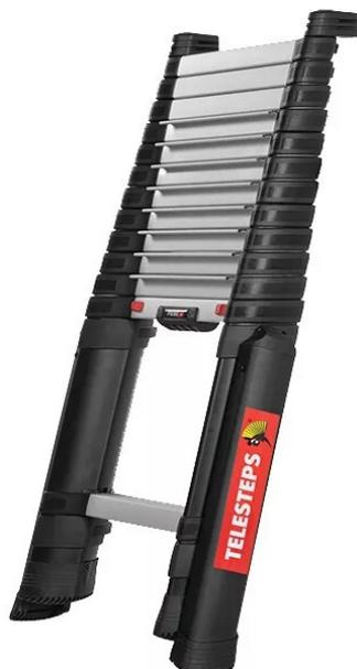
Son profilé au design triangulaire révolutionnaire lui apporte une rigidité et une robustesse inégalée. Déverrouillage simple et rapide à l'aide de ses 2 boutons entièrement automatiques. Conçue pour être utilisée avec un angle d'inclinaison de 75°. Ses larges marches de 80 mm inclinées et rainurées restent bien parallèles au sol ce qui assure une parfaite sécurité en toute circonstance. 13 échelons.
