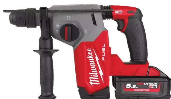
Très polyvalent (4 modes de perçage/burinage), le perforateur M18 FHX-552X possède un système AVS anti-vibrations et une meilleure gestion de la poussière pour un environnement de travail plus sain. Son système Fixtec™ permet d'intervenir entre l'emmanchement SDS Plus et le mandrin auto-serrant 13 mm.
