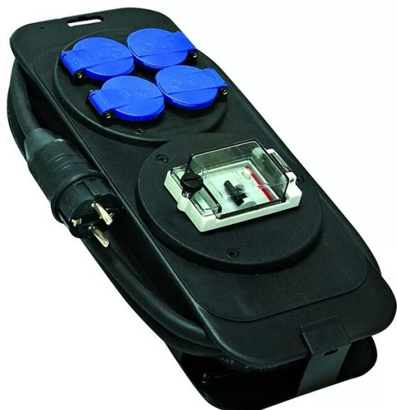
Distributeur de courant en plastique robuste équipé d'un interrupteur différentiel 30 mA 25 A, pour assurer la protection des personnes. Boîtier isolant antichocs avec perçages pour fixation au mur. Muni d'un socle à 4 prises 2P+T 16A / 230V à clapets. IP44. Garantie 2 ans.
