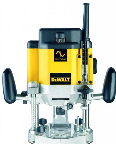
Carter en aluminium haute qualité avec guidage de précision par 2 colonnes coulissantes dans de larges bagues en bronze. Profondeur de défonçage avec réglage millimétrique par mollette crantée et tourelle 3 butées. Poignées larges avec bouton marche/arrêt et bouton de verrouillage en continu pour un travail confortable et sécurisé. Avec démarrage progressif. Verrouillage de plongée par simple pression. Profondeur de plongée : 80 mm.
