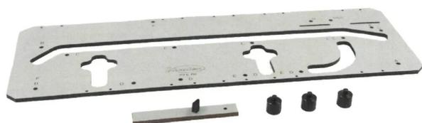
Gabarit de profilage pour plan de travail. Appareil de conception robuste de 12 mm d'épaisseur, permettant l'usinage et l'assemblage des plans de travail, largeur 420 à maxi 650 mm, angles d'assemblage 45° ou 90° ainsi que l'usinage d'un rayon (arrondi extérieur). Fixation du gabarit à l'aide de serre-joints ou de 2 ventouses minimum.
