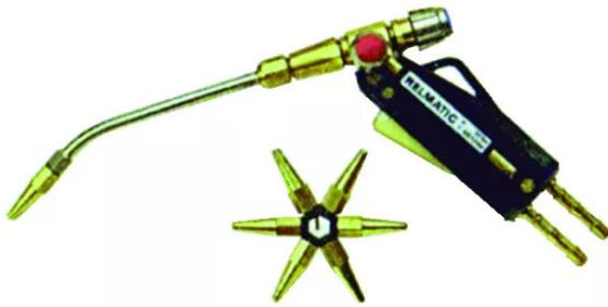
Idéal pour le travail en position. Relmatic supprime la nécessité de procéder à un nouveau réglage après chaque interruption de travail. Muni de 7 buses, il pèse 450 g. Raccord d'entrée : douilles fixes  $\varnothing$  6,3 mm. Gamme de débit en l/h : 40 à 400.
