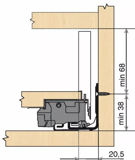
Tiroir à bords droits et fins épaisseur 12,8 mm montés sur coulisses invisibles extra-plates. Coulissement extra-léger. Amortissement BLUMOTION à la fermeture. Versions TIP-ON et TIP-ON BLUMOTION pour solutions sans poignées. Tiroir M : hauteur côté = 90,5 mm. Cote d'encastrement 106 mm.
