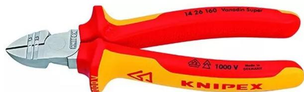
La pince indispensable pour l'installation électrique. Trous de dénudage précis fils de 1,5 et 2,5 mm<sup>2</sup>. Tranchants de précision trempés par induction, pour fils doux d'un diam. max. de 4,0 mm, dureté d'env. 60 HRC. Acier électrique au vanadium, forgé, trempé à l'huile.
