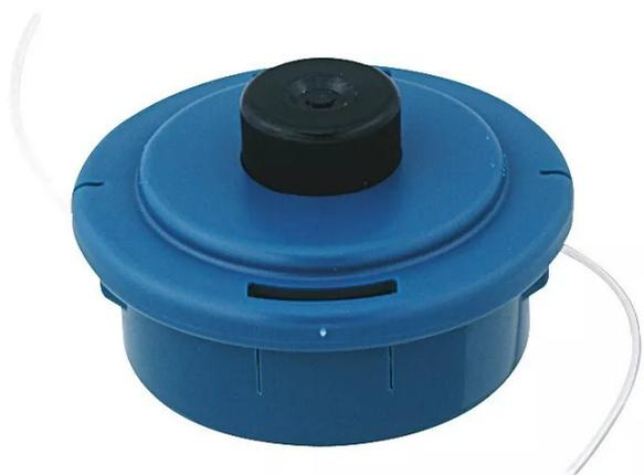
Sortie semi-automatique du fil de coupe lorsque la tête frappe le sol. Le fil est alors libéré et la force centrifuge adapte sa longueur selon le besoin rencontré. Pour débroussailleuse DOL 117.
