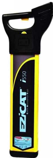
EZiCAT i550 indique la profondeur d'un réseau en combinaison avec EZITEX dans les modes 8 ou 33 kHz (à une distance d'environ 30 cm). Les opérateurs peuvent déterminer la profondeur du réseau souterrain, ce qui constitue un avantage lors de levés de sol. Démarrage en mode
