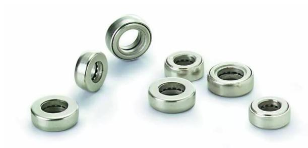
En acier nickelé. Roulement à billes pour paumelles. Améliore la qualité de frottement des paumelles et augmente significativement la charge admissible.
