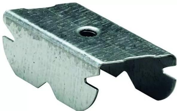
Pièce en acier galvanisé avec trou fileté de  $\varnothing$  6 pour fourrure 45 et 47. Suspension pour fourrure pour la réalisation de plafond en plaque de plâtre à accompagner d'une tige fileté  $\varnothing$  6 mm. Produit compatible fourrure 45 et 47. Fabrication Française.
