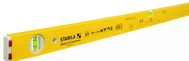
Encoches pour le tracé des entraxes de robinetteries de salles de bains. Informations imprimées sur toutes les mesures d'installation usuelles. Fiole à six anneaux pour la définition d'inclinaisons de 1 % et 2 %. Embouts avec patins antidérapants et barre continue au-dessus de la fiole horizontale. Idéal pour le traçage. Système d'aimants aux terres rares très puissants.
